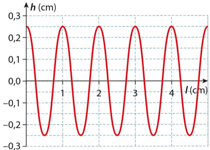
À  $t_2 = 0,060 \text{ s}$ , il s'est encore écoulé une demi période. L'aspect de la surface de l'eau est décalé d'une demi-longueur d'onde.
