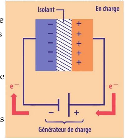
Contrairement aux batteries, qui utilisent des réactions chimiques pour stocker l'énergie, les supercondensateurs conservent l'énergie grâce à la séparation des charges électriques sur leurs électrodes. Cela leur permet d'être rechargés et déchargés très rapidement sans dégradation significative.
